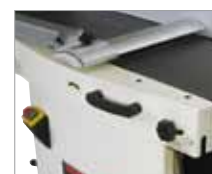
Exzenter-Schnellverstellung des Aufgabebetisches
