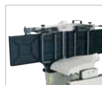
Sekundenschneller Wechsel von Abrichten auf Dickenhobeln
